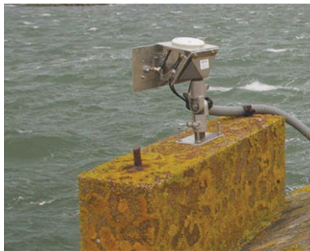
图3 GPS海平面测高接收机
